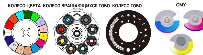
Внимание: размер гобо: внешний - 15.9 мм, внутренний - 11 мм
