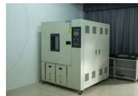
Программируемый стенд тестирования воздействия температуры и влажности
